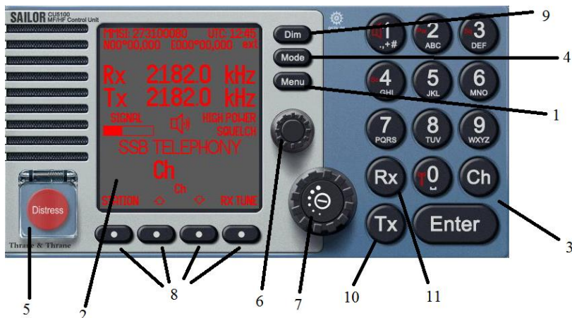
Рис. 9.1. Органы управления и индикаторы станции
