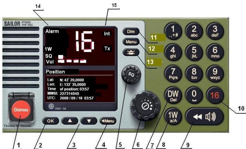
Рис. 8.1. Внешний вид и органы управления радиостанцией
