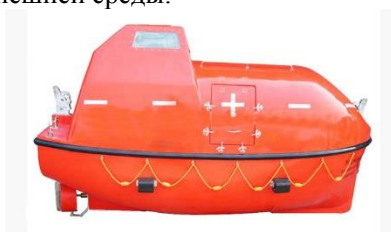
Рис. 2. Спасательная шлюпка закрытого типа
