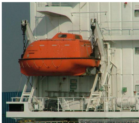
Рис. 48. Установка на судне шлюпки, спускаемой на лопарях
