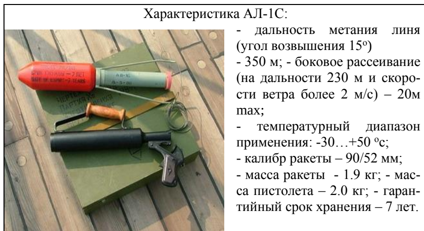
Рис. 66. Комплект линеметательного устройства АЛ-1С российского производства: ракета, пистолет, патрон для поджигания ракеты, линия.
