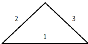
Рис. 4. Пожарный треугольник 1 – ГВ; 2 – теплота; 3 – кислород
