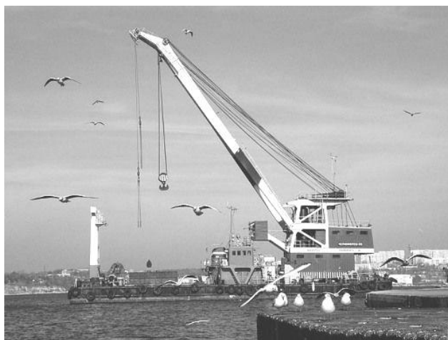
Рис. 14 Плавучий кран «Черноморец» грузоподъёмностью 100 т.
