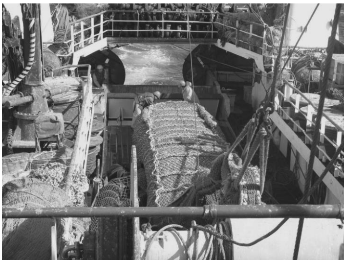
Рис. 19 Подъём трала по слипу на промысловом судне
