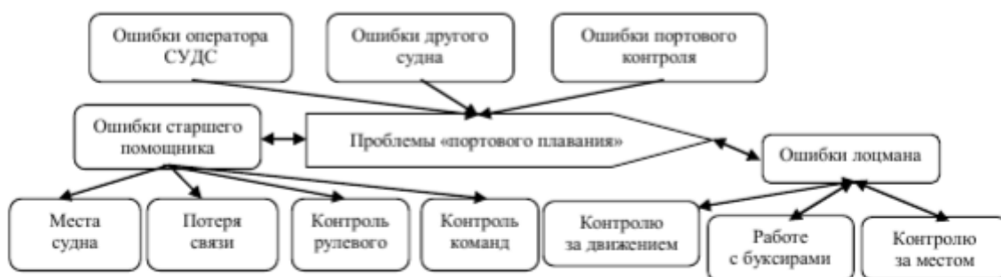
Рис. 1. Схема возможных рисков при «портовом плавании».
