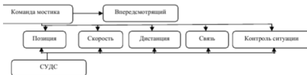
Рис. 6. Схема организации команды мостика при работе с СУДС
