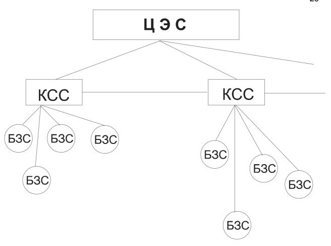
Рис. 1. Структура наземного сегмента системы Инмарсат.
