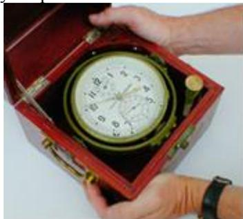
Перед пуском желательно (первоначально) установить стрелки так, чтобы он показывал гринвичское время на несколько минут больше текущего гринвичского времени. При переводе и установок стрелок на требуемый отсчет хронометра предварительно надо взять его на стопор, затем отвинтить стеклянную крышку.
