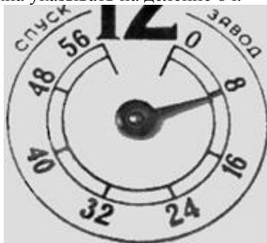
А перед заводом при условии регулярного завода в одно и то же время стрелка циферблата завода должна указывать на деление с цифрой 32ч.
