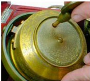
Для пуска остановившегося хронометра надо предварительно завести хронометр, сообщая ему двухсуточную порцию завода (14-15 полуоборотов ключа), и не слишком резко повернуть ящик с механизмом хронометра вокруг вертикальной оси на 450-500
