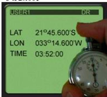
Подойдя к штурманскому хронометру с секундомером, останавливают секундомер в удобный момент времени, когда показания секундной стрелки хронометра соответствуют 30 или 60 секундам.
