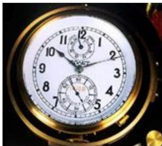
По циферблату завода движется стрелка, которая показывает количество часов, протекшее с момента завода хронометра
