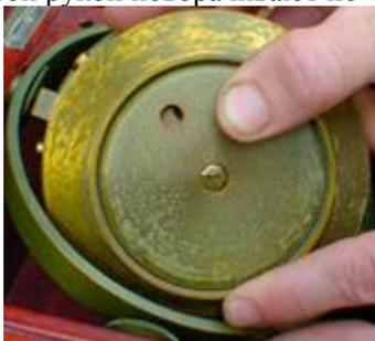
Вставляют заводной ключ и аккуратно делают 7-7,5 полуоборотов ключа против часовой стрелки (!). Если заводить непроворачивающимся ключом по часовой стрелке, то можно испортить механизм хронометра. Затем вытаскивают ключ из отверстия и осторожно возвращают хронометр в прежнее положение
