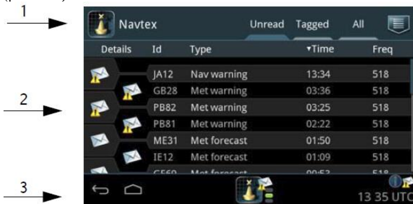
Рис. 11.2. Экран приёмника Навтекс
