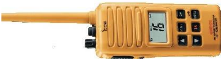
Рис. 1. Переносная УКВ радиостанция
